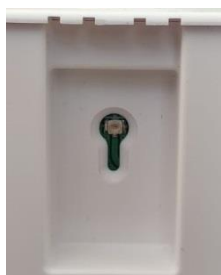
Рисунок 3.1 — U.FL-разъем для подключения GSM-антенны
