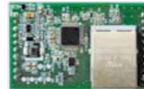
Ethernet-модуль для контроллеров STEMAX MX840, STEMAX SX830, STEMAX MX830.
