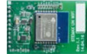
Wi-Fi-модуль для контроллеров STEMAX MX840, STEMAX SX830, STEMAX MX830.
